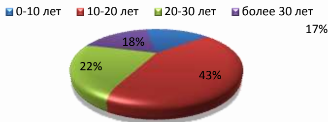
Рис.: Распределение газопроводов поселения по сроку эксплуатации.
